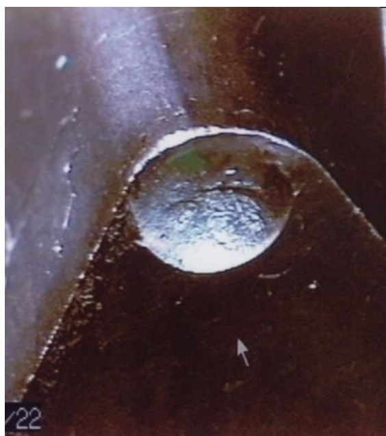
Figura N°4- Tipica usura per craterizzazione su un creatore
